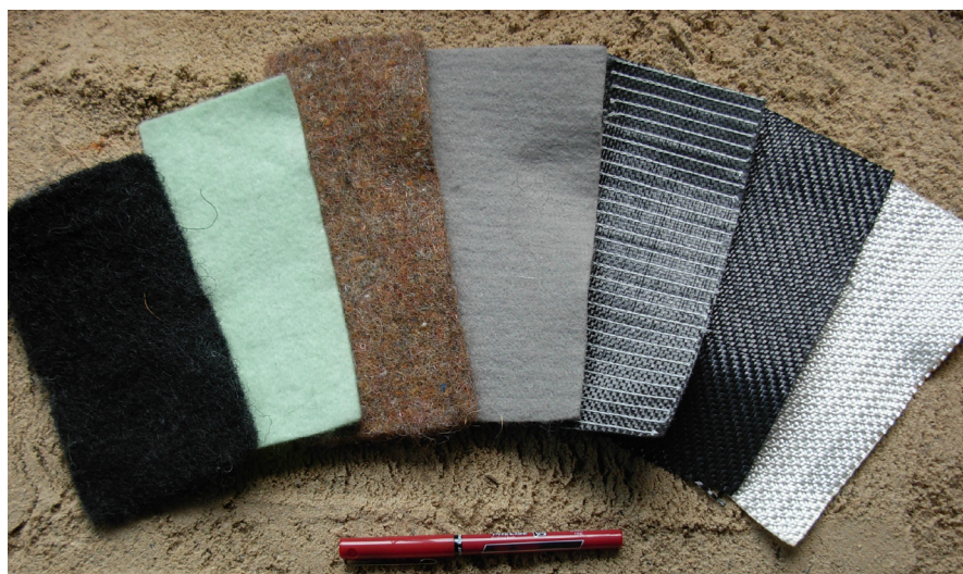
Przykłady geowłóknin i geotkanin, źródło: Wikipedia
