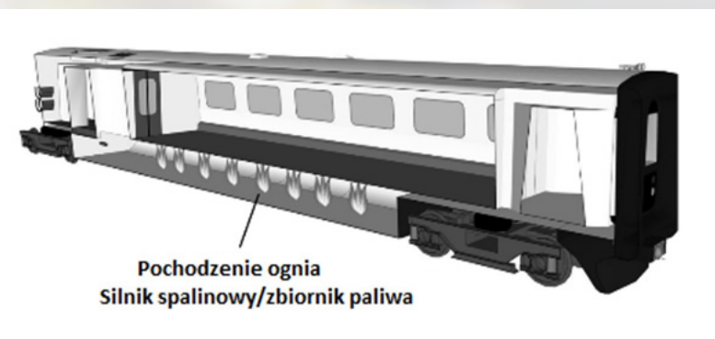
Rys. 3. Pożar typu 3 – rozmiar i/lub lokalizacja zagrożenia urazami i/lub utratą życia nie daje szansy na określenie uzasadnionych i wykonalnych wymagań dla zdolności do jazdy
