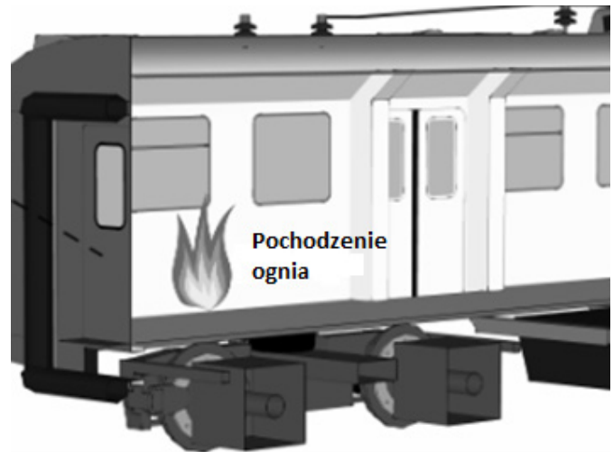
Rys. 1. Pożar typu 1 – brak zagrożenia urazami i/lub utratą życia nie powoduje potrzeby określenia wymagań dla zdolności do jazdy
